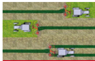
Andana doppia, larghezza di lavoro 300 cm. / Double swath raking, working width 300 cm (9'10"). / Hilerado doble, ancho de trabajo de 300 cm. / Andaine double, largeur de travail de 300 cm.
