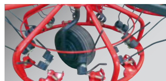
Denti azionati da forza centrifuga. / Centrifugal force controlled tines. / Dientes controlados por medio de fuerza centrifuga. / Dents commandées par force centrifuge.
