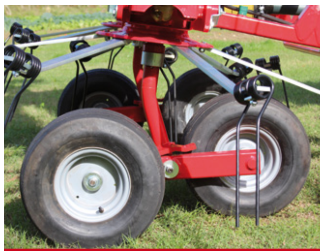
Ruote tandem nel G6V PTH. / Tandem axles on G6V PTH. / Ruedas tandem en el G6V PTH. / Roues tandem dans le G6V PTH.
