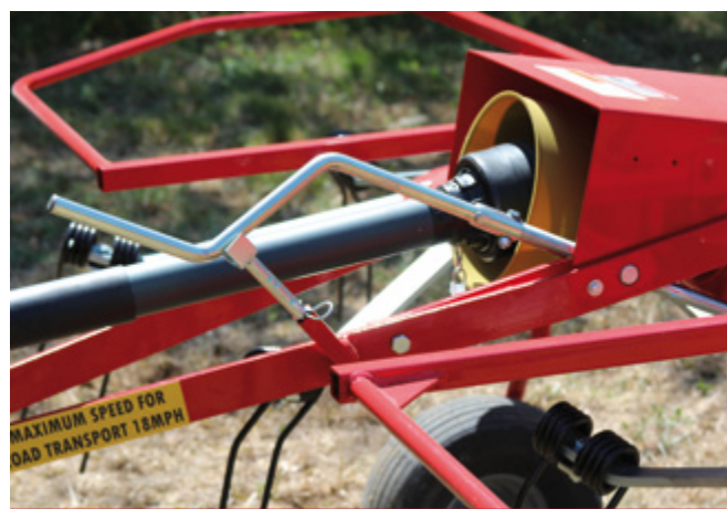
Regolazione dell'inclinazione in fase di lavoro. / Tilting adjustment during working. / Ajuste inclinación durante el trabajo. / Reglage de l'inclinaison pendant le travail.
